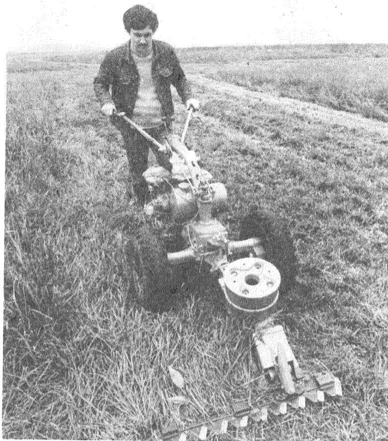
BALTKRIEVIJAS PSR. Modernizētu zāles pļaujmašīnu sērij- veldā izlaidi apguvis ražošanas apvienības «Gomeļas lauksaimniecības mašīnu rūpnīca» Svetlogorskas uzņēmums. Šis pļaujmašīnas paredzētas minitraktoram MTZ-0,5. Jaunās modernizētās pļauj- mašīnas var izmantot darbam piemājas saimniecībās un dārzos. Tās var būt sevišķi noderīgas lauku iedzīvotājiem.
