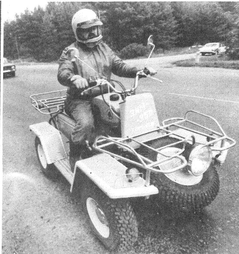
UKRAINAS PSR. Harkovas transporta mašīnbūves rūpnīca, kurai piešķirts Maļiševas vārds, radījis traktorā ar labām pārejām spējām, kam ir astoņi pārvadi un 350 kubikcentimetru liels dzinējs. Uz asfaltēta ceļa tas ļauj sasniegt ātrumu līdz 60 kilometriem stundā, bet bezceļa apstākļos pārvadā kravu līdz 300 kilogramiem.
