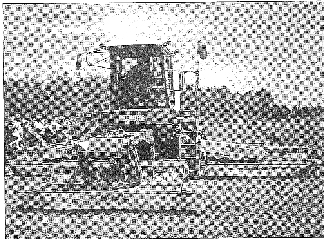
● Jaudīgākais agregāts no šogad piedāvātajām zāles plaujmašīnām. Viena vāla platums aptuveni 12 metri. Preiļu LKB foto
