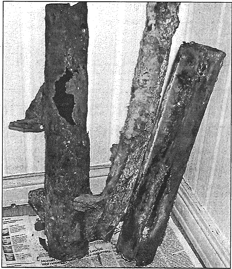
● SIA «Preiļu saimnieks» siltumapgādes un ūdens un kanalizācijas nodaļas vadītāja kabinetā izveidota īpatnēja kolekcija, kur daļa no eksponātiem liecina, cik nolietotās ir siltumapgādes, kā arī ūdens un kanalizācijas caurules. Foto: M. Rukosjus
