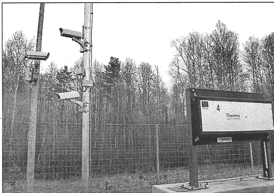
● Jaunā transportlīdzekļu un konteineru automātiskās identificēšanas sistēma (stends pa labi) paredzēta valsts robežu šķērsojošo automašīnu numura zīmju un konteineru numuru noteikšanai un pārbaudīšanai.
