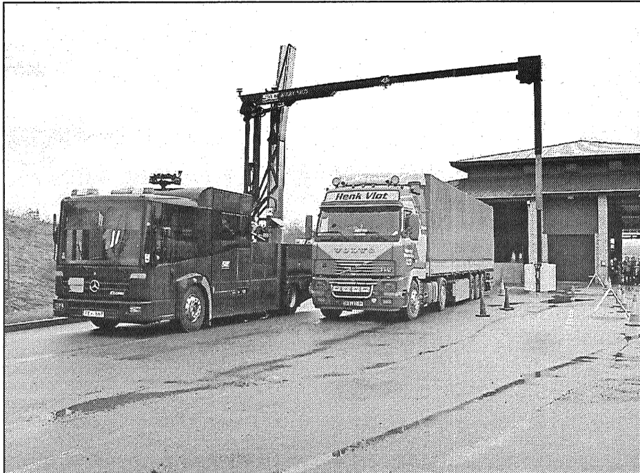
● Automašīna — rentgens (pa kreisi), virzoties ar kameru gan transporta līdzekli, noskenē visu konteineru saturu un palīdz noteikt, kur noslēpta nelegālā prece. Foto: A.Dzerkalis
