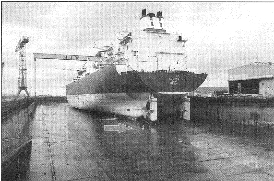
● “Es un mans kuģis” — tā, sūtot uz redakciju publicēšanai domāto fotogrāfiju, pavadvēstulē rakstīja Aldis. Patiešām milzenis, kura divi dzinēji attīsta katrs 22 500 zirgspēku jaudu un diennakti patērē 120 tonnas degvielas.
