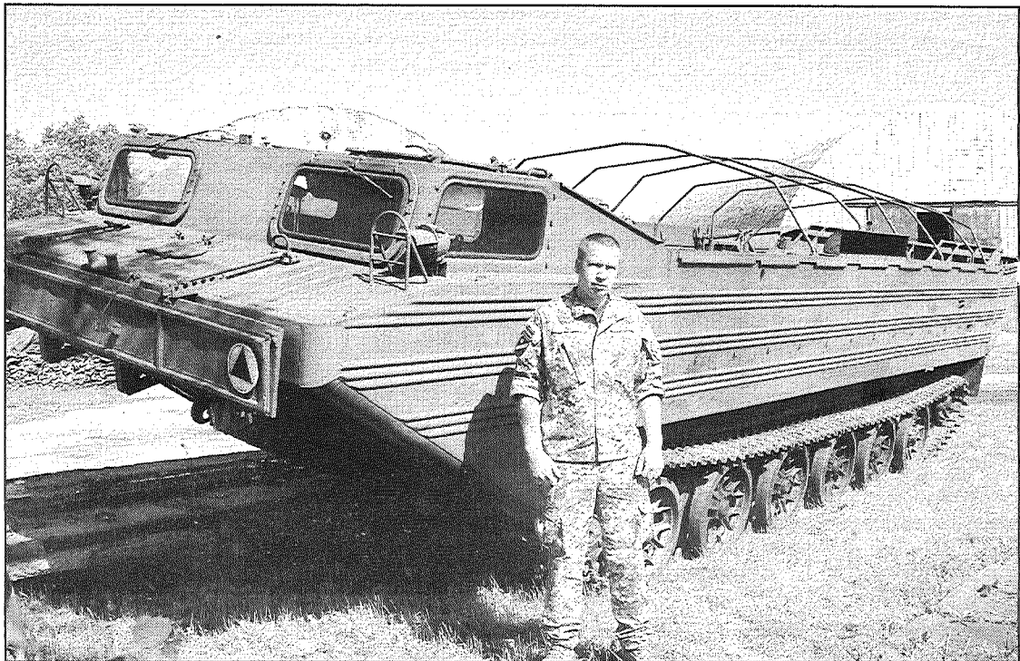
● Zemessardzes 35. bataljona viri pašlaik veic amfibijas PTS remontu. Transportlīdzeklis pa zemes ceļu sasniedz 70 kilometru ātrumu stundā, bet pa ūdeni pārvietojas ar 40 kilometru ātrumu stundā. Attēlā: atbildīgais par transportu seržants Aleksandrs Ilčukovs.
