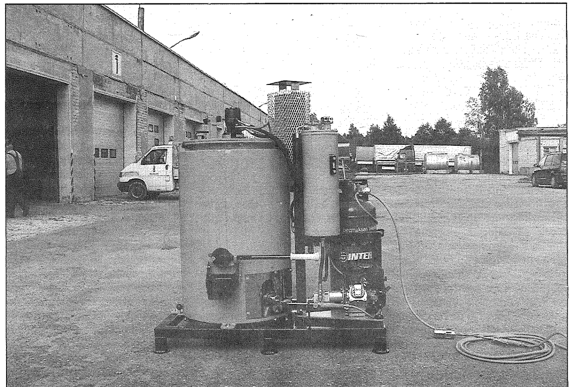
● Bitumena mastikas sildīšanas iekārta tiltu deformācijas šuvju aizpildīšanai. Foto: A. Svarinskis
