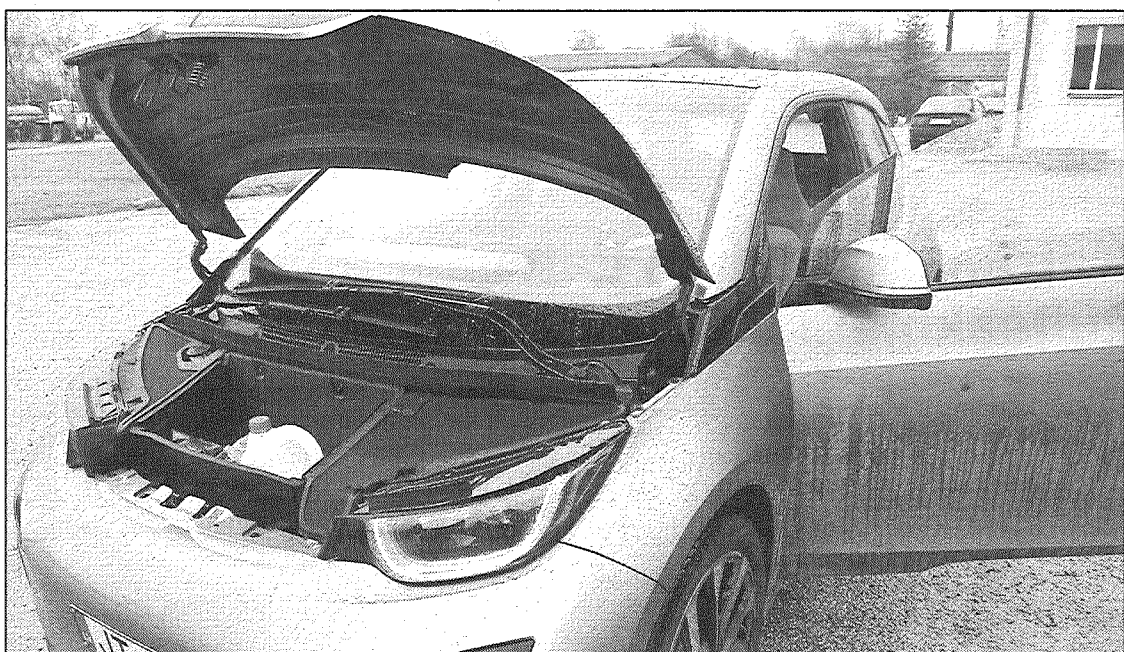
● Tur, kur parastam benzīnīkam zem pārsega slēpjas dzinējs, elektroautomobilim ir neliels nodalījums, tāda kastīte, kur glabājas stiklu tīrīšanas šķidrums.
