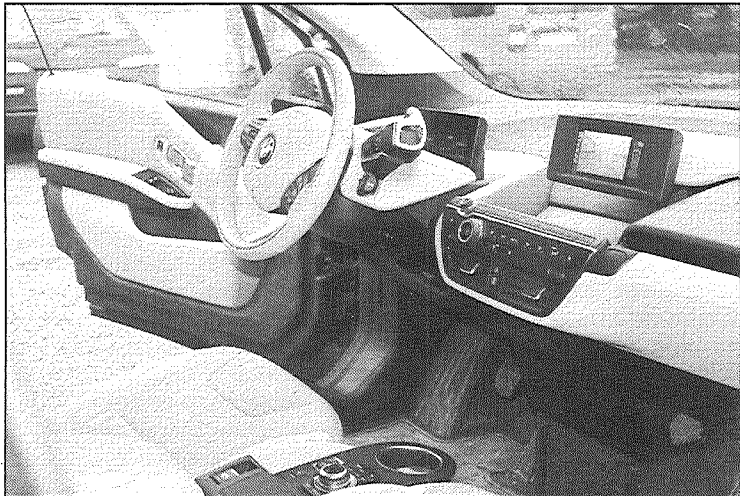
● Salona iekšpusē izskatās savādāk, nav nedz ātrumu pārslēgkloka, nedz vietas aizdedzes atslēgai (jo tādas vispār nav, ir tikai čips), toties papildinām dažādas elektronikas.
