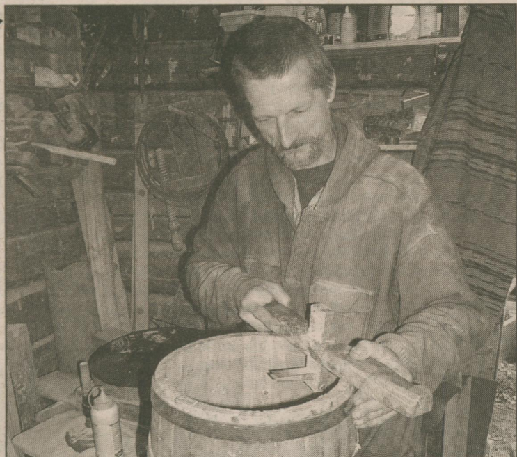
● Ķimeņgriezis (ķimeņgrauzis) ir instruments, ar kura palīdzību amatnieks Juris Kivlenieks koka traukam izgriež rievu, kurā ievietot atbilstoši šķēsgriezuma formai izgatavotu trauka dibenu.
